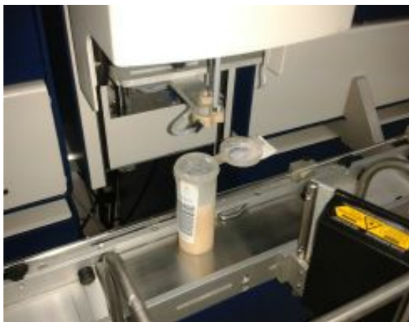
Figura 7: Equipo automático de laboratorio que utiliza el principio FTIR en la leche. Permite determinar concentraciones de grasa, proteína, lactosa, MUN, cuerpos cetónicos, ácidos grasos, sólidos no grasos en leche, caseínas, entre otros componentes.
