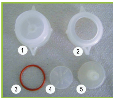
Figura 1.23 Partes de un filtro autoclavable. 1) Cuerpo, 2) tapa de cierre, 3) empaque, 4) soporte de la membrana, 5) tapa de la membrana.
