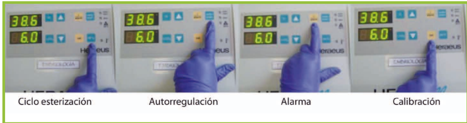
Figura 1.7. Funciones básicas para la graduación de la incubadora de \text{CO}_2 .
