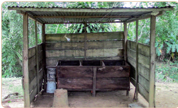
Figura 43. Características del cajón fermentador para cacao
