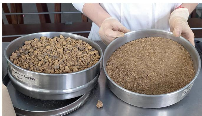
**Figura 3.** Tamizado de las muestras de suelo con tamiz de malla de 2 mm
