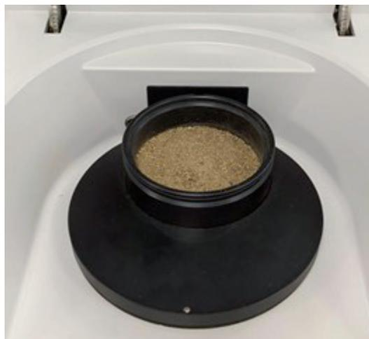
**Figura 5.** Muestra de suelo preparada para su lectura en el equipo NIRS
