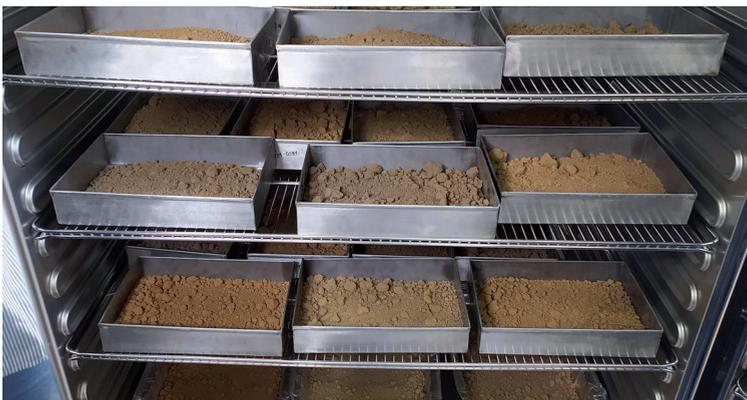
**Figura 2.** Muestras de suelo secando en horno de ventilación forzada
