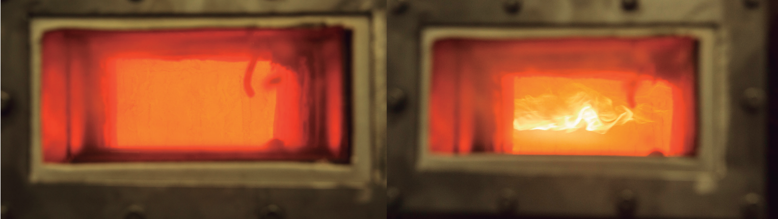
Horno desarrollado y patentado por el grupo Gasure, operando en los modos sin llama y con llama.
