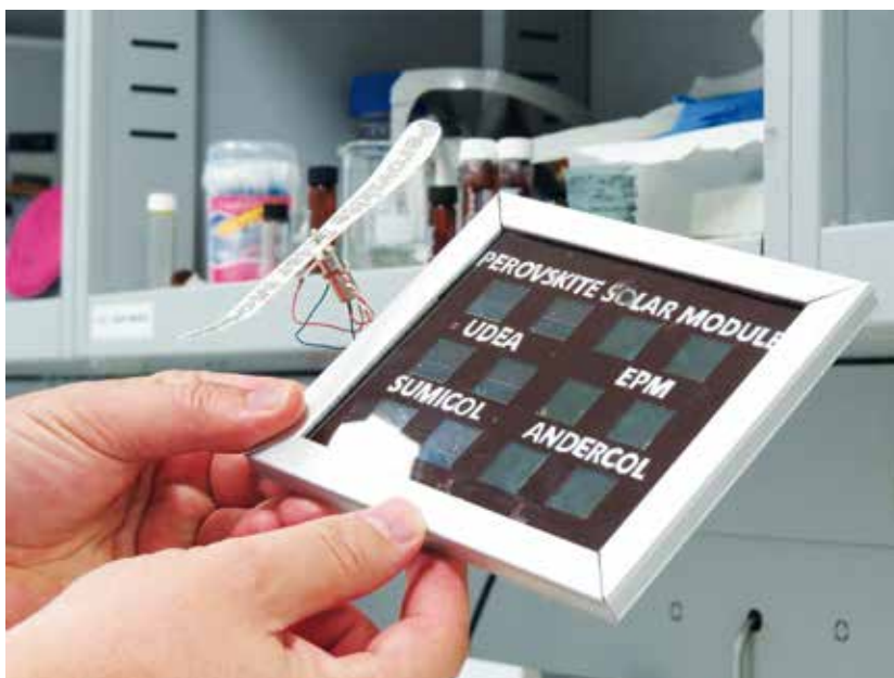
Los investigadores también han desarrollado una celda solar fotovoltaica usando perovskita híbrida, un nuevo material fotoactivo que ha mostrado tener eficiencias similares a las del silicio.
