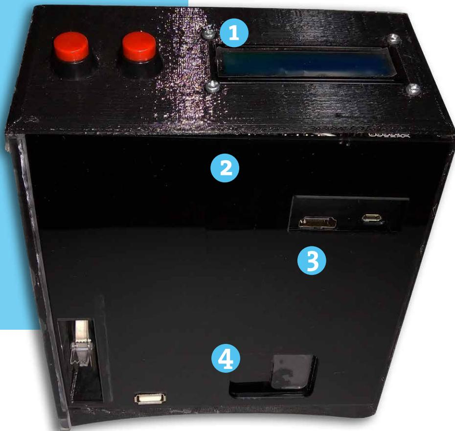
Estructura del dispositivo para una lectura objetiva de las tirillas de cloro, diseñado y construido en el Semillero de Investigación en Desarrollo Agroindustrial de la Universidad de Antioquia, Seccional Oriente.
