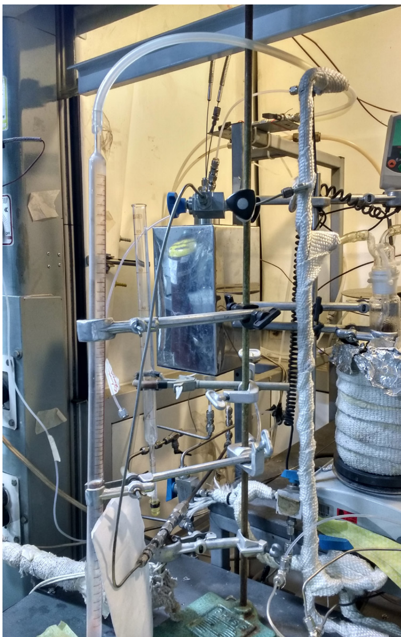
Figura 2. Sistema de reacción utilizado para evaluar sistemas catalíticos de depuración
