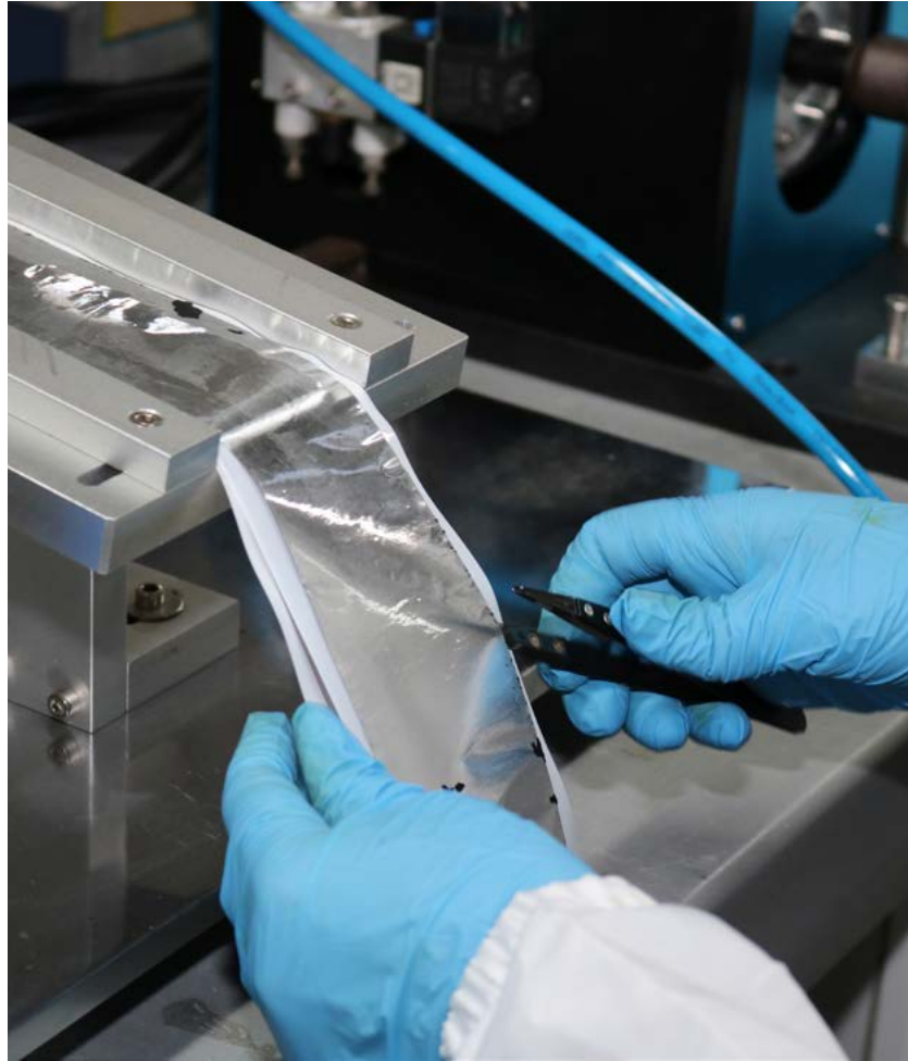
Enrollado de electrodos durante el ensamble de una celda de ion-litio. Fotografía: Cortesía de los investigadores.
