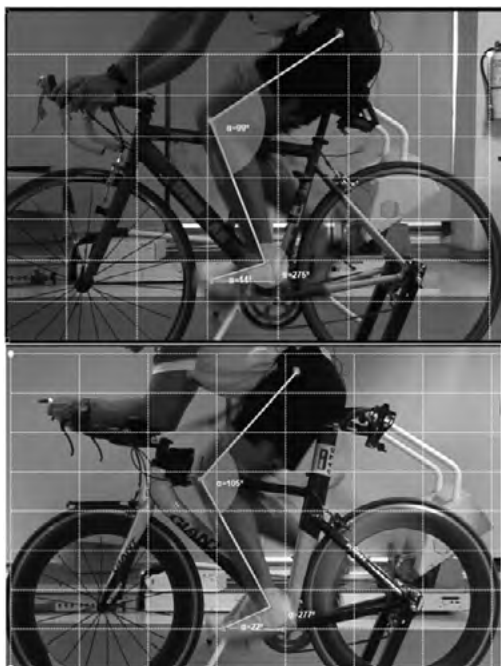
Figura 1. Imágenes tomadas del software KINOVEA®. La imagen superior corresponde a la bicicleta convencional, mientras que la inferior corresponde a la bicicleta aerodinámica. Las líneas fueron trazadas a partir de la posición de los marcadores del deportista.
