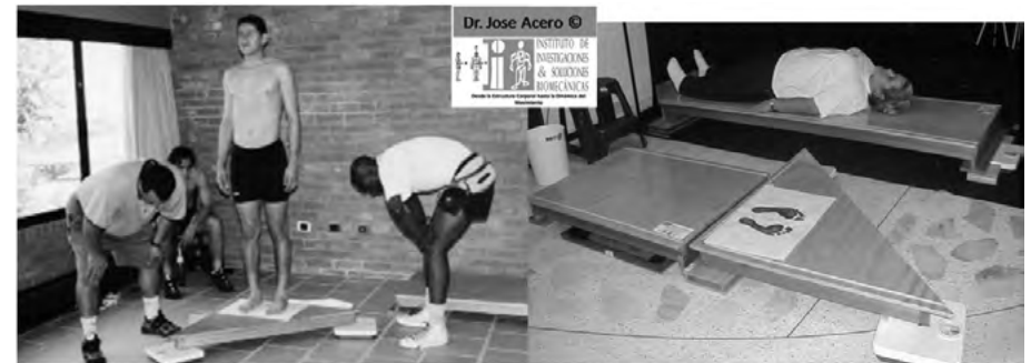
Figura 5. Determinación de Centro de Masa (3P) por el método de reacción En Acero, 2002a
