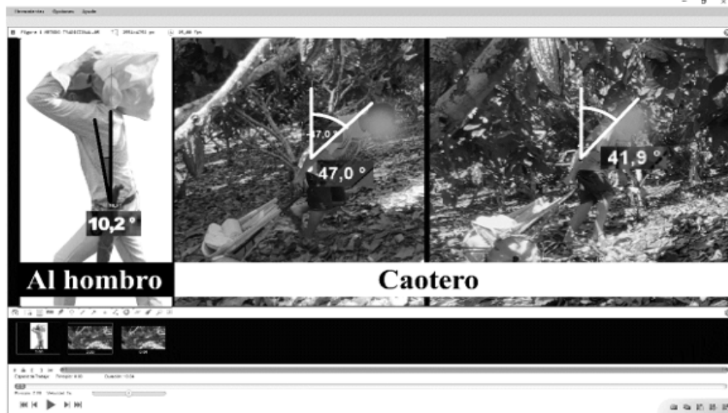
Figura 3. Ángulos de la espalda según herramienta, usando Kinovea (Joan Charmant, Versión 2023.1.2).
