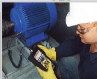
ANÁLISIS DE VIBRACIONES Para tener un mantenimiento predictivo y evitar paros de sus equipos
