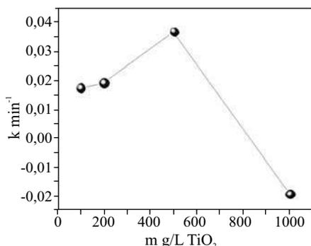
**Figura 3** Variación de la constante de la velocidad de degradación con la concentración del  $TiO_2$  (mg/l) en la fotocatalisis del Clorotalonilo
