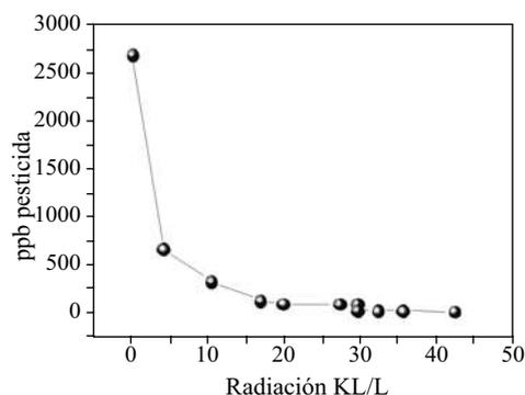
**Figura 5** Degradación de 2,0 mg/l de Clorotalonilo en función de la radiación acumulada en la fotocatalisis con TiO<sub>2</sub> y persulfato de sodio
