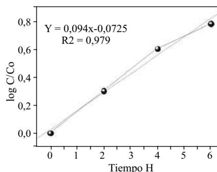
**Figura 6** Verificación de la cinética de primer orden de degradación del Clorotalonilo en la fotocatalisis con TiO<sub>2</sub> y persulfato
