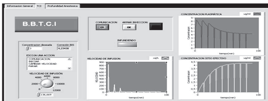
Figura 5 Interface del sistema de administración de anestesia en lazo cerrado aplicado a un paciente simulado tipo ASA2
