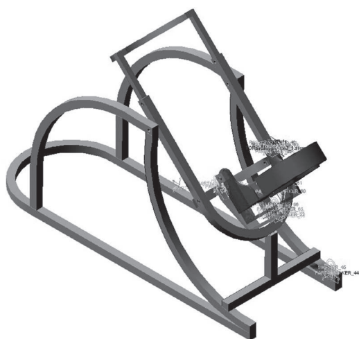
Figura 19 Prototipo virtual del rehabilitador de tobillo de 3gdl en ambiente de ADAMS
