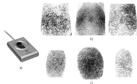
Figura 1 a) Lector óptico usado, b) Ejemplo de imágenes obtenidas con nuestro lector, c) Ejemplo de imágenes usadas de la base de datos FVC2002
