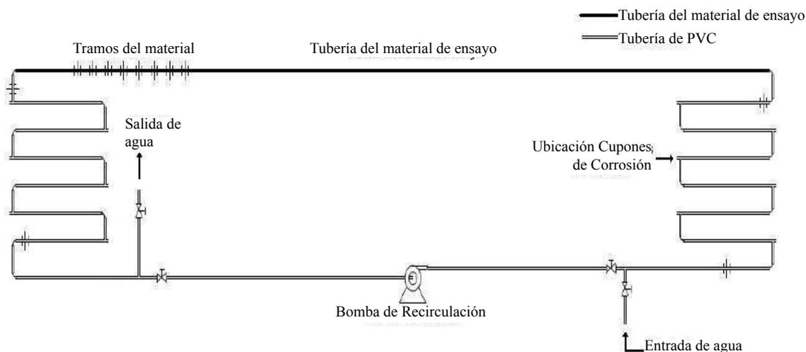
**Figura 1** Esquema del sistema piloto
