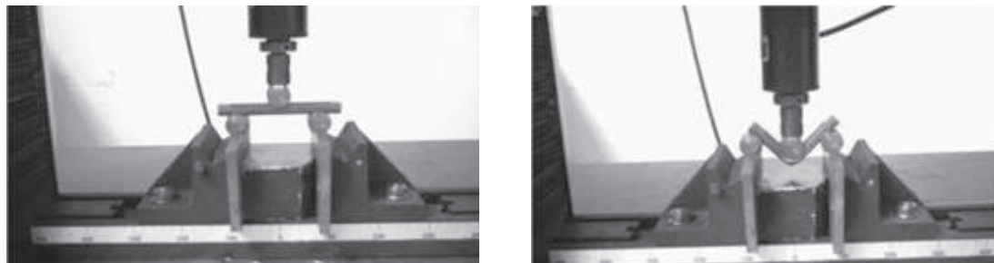
Figura 6 Montaje para ensayos de esfuerzo según norma ASTM D4475-85
