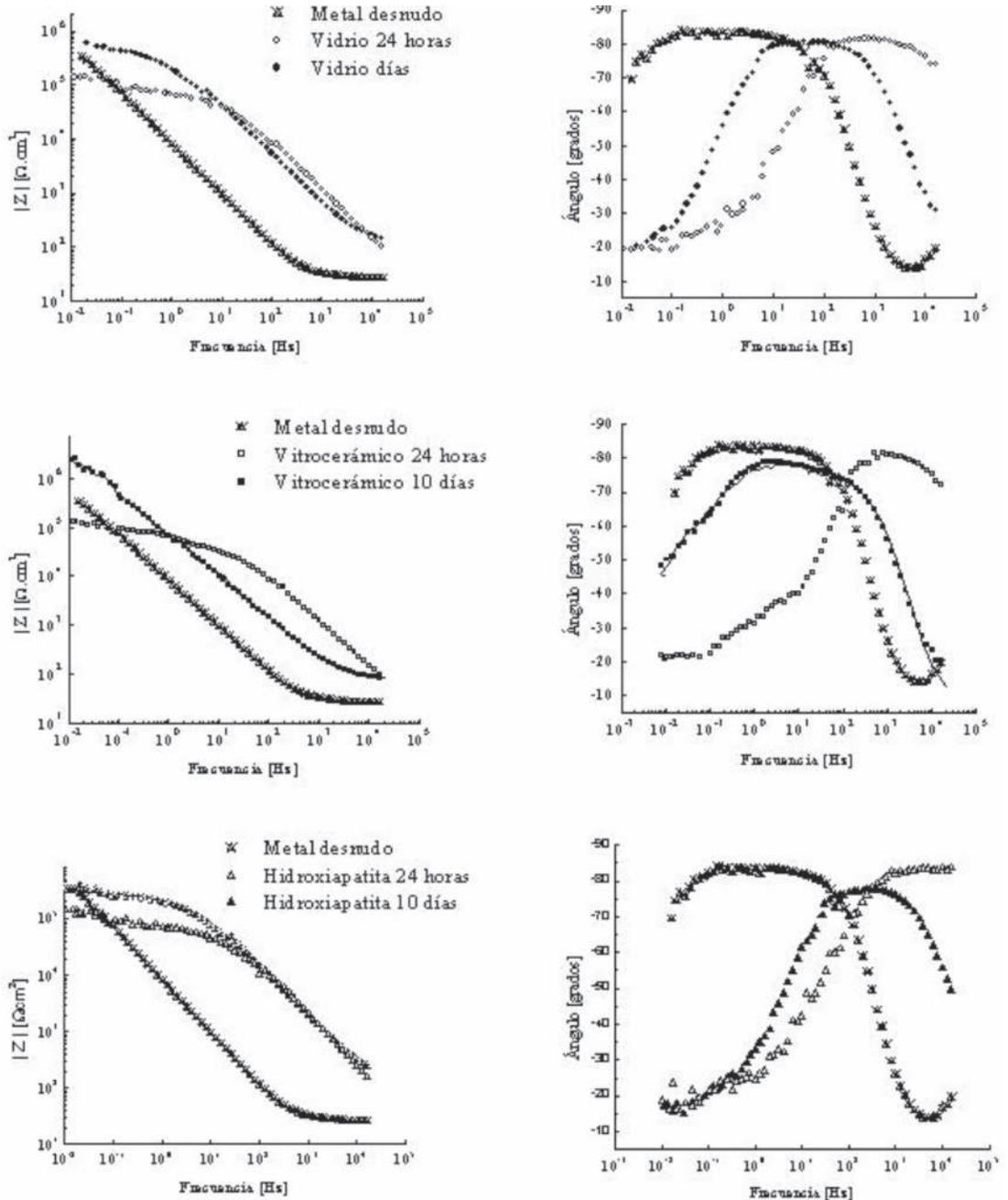
**Figura 3.** Diagramas de Bode de los recubrimientos doble capa con partículas de (a) vidrio, (b) vitrocerámico y (c) hidroxiapatita después de 24 h y 10 días de inmersión en SBF
