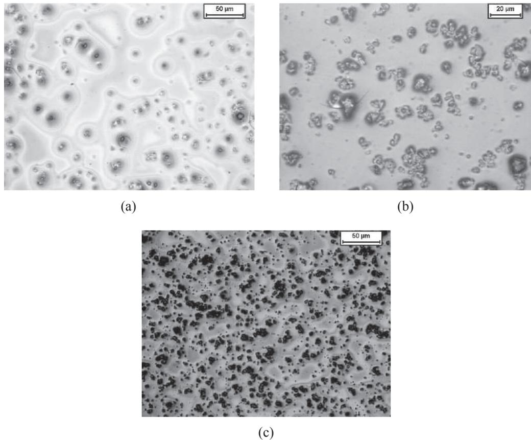
**Figura 1** Micrografías de los recubrimientos con partículas de (a) vidrio, (b) vitrocerámico (c) hidroxiapatita
