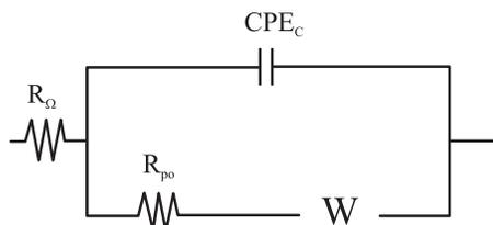
**Figura 4** Circuito eléctrico equivalente utilizado para el modelado de la aleación Ti6Al4V con recubrimientos doble capa con partículas de vidrio, vitrocerámico e hidroxiapatita después de 24 h y 10 días de inmersión en SBF
