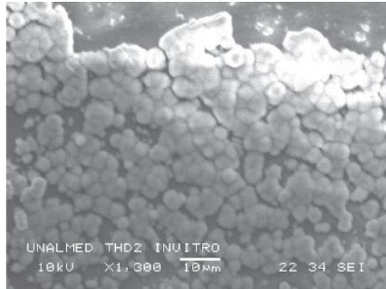
**Figura 5** Fotomicrografía de la superficie del recubrimiento doble capa con partículas de hidroxiapatita después de 14 días de inmersión en SBF
