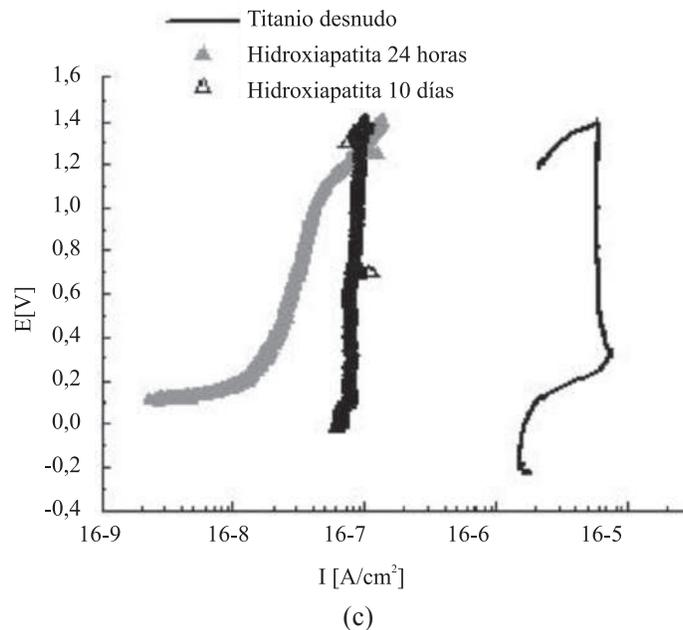
**Figura 2** Curvas de polarización potenciodinámica correspondientes a la aleación Ti6Al4V desnudo y con recubrimientos doble capa con partículas de (a) vidrio, (b) vitrocerámico y (c) hidroxiapatita después de 24 horas y 10 días de inmersión en SBF
