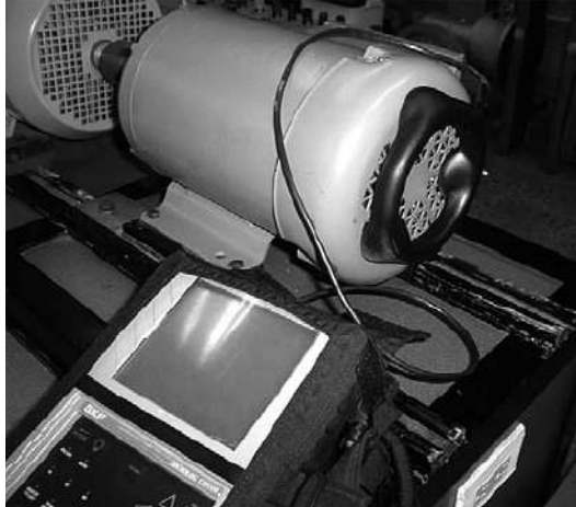
Figura 3 Medición de flujo axial con el prototipo de mejores resultados
