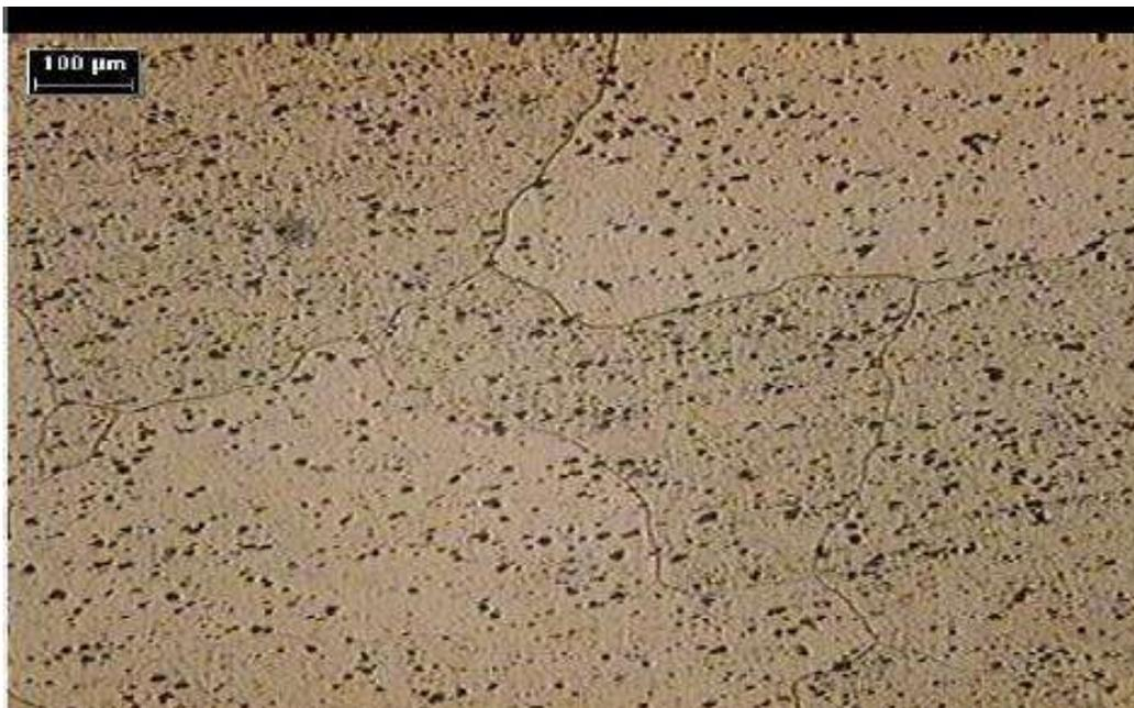
**Figura 20.** Microestructura de un aluminio 6061 T6 (50X).
