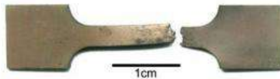
Figura 16. Probeta de termofluencia del acero con 20%Ni, 14%Cr y 2.5% Al, ensayado a 750° C, con una tensión de 100 MPa, al aire, durante 2191 horas. Se ve poca oxidación.
