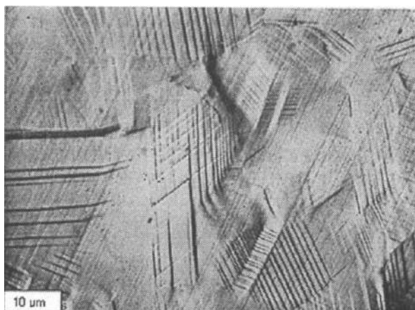
Figura 3. Las líneas de deslizamiento en el acero Hadfield se cruzan entre sí, sin desviación, aún después de deformaciones plásticas del 35%.
