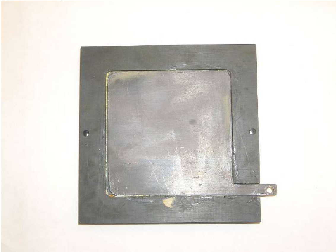
Figura 5. Ánodo de plomo utilizado en el reactor electroquímico a escala piloto.
