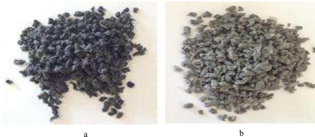
**Figura 2.** a. Pellets de CaCO<sub>3</sub>/PVC; b. Pellets lodo/PVC
