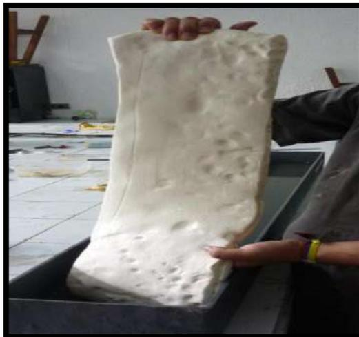
**Figura 2.** Lamina cuagulada con mezclas seleccionadas
