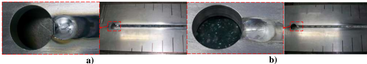
Figura 2. Grietas de cráter presentes en los ensayos de soldabilidad de Battelle con material de aporte a) ER5087 y b) ER5356
