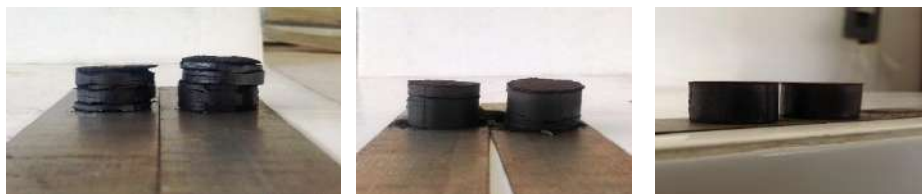
Figura 2. Briquetas prensadas con carga de: a) 2 toneladas métricas, b) 4 toneladas métricas, c) 10 toneladas métricas
