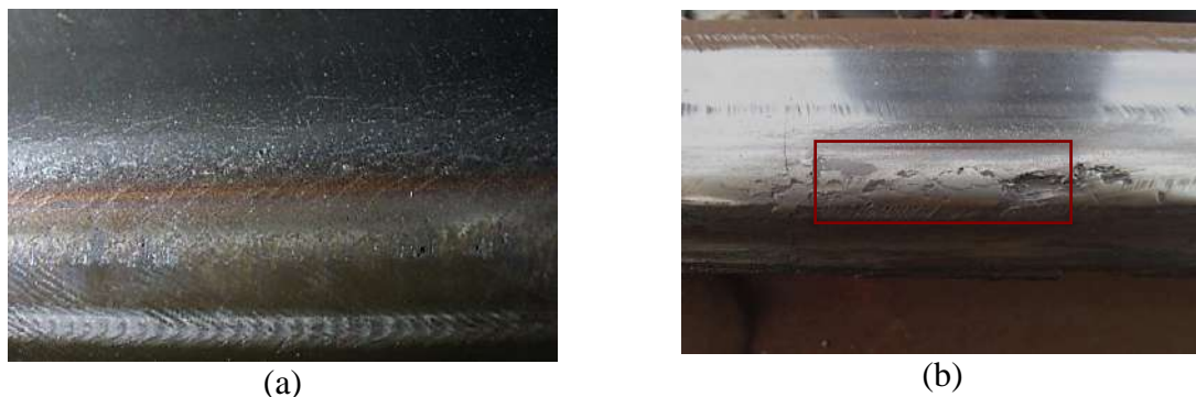
Figura 3. (a) Agrietamiento en la cabeza del riel ( head checks ). (b) desprendimiento de material debido a fatiga. Imágenes tomadas del Metro de Medellín, curva 4 y 8 respectivamente.
