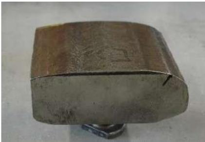
**Figura 1.** Sección extraída de la cabeza de riel.
