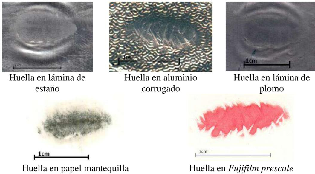
Figura 4. Área de contacto medida con los diferentes materiales de prueba.
