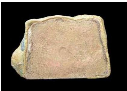
**Figura 4.** Capa dorada obtenida luego de cuatro ciclos de dorado. Se observa la presencia de productos del decapado.
