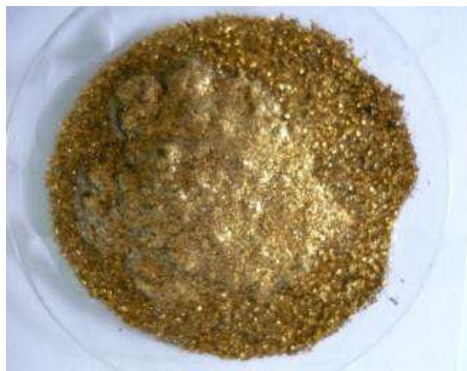
Figura 1. Oro recuperado en estado no lixiviado
