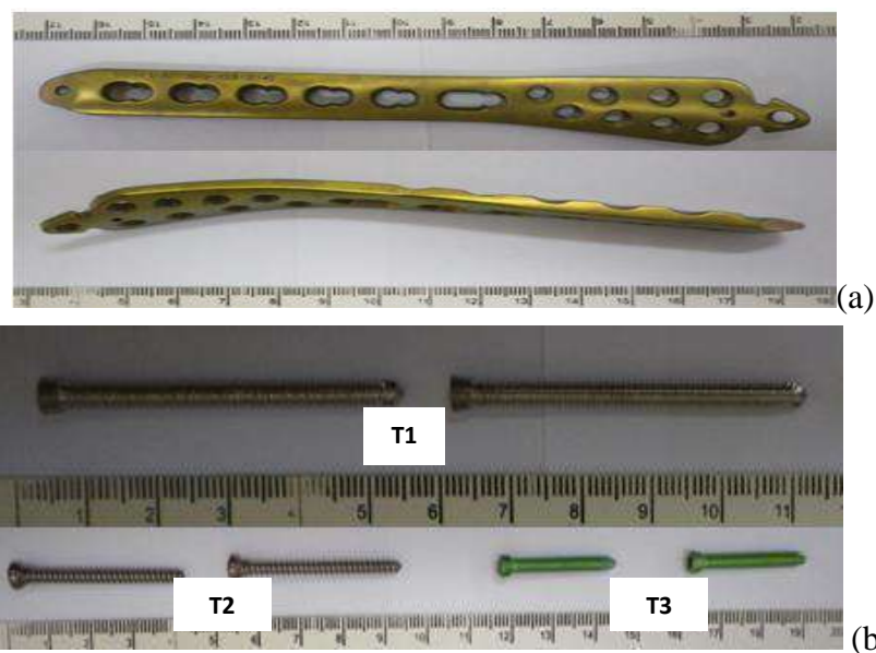
Figura 1. (a) Placa anatómica distal medial de tibia y (b) tornillos de bloqueo de acero inoxidable (T1 y T2) y de titanio (T3).
