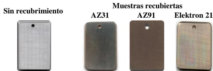
**Figura 2.** Aspecto superficial de los recubrimientos.
