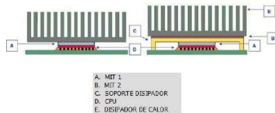
Figura 1. Ensamble típico de una unidad de procesamiento principal.
