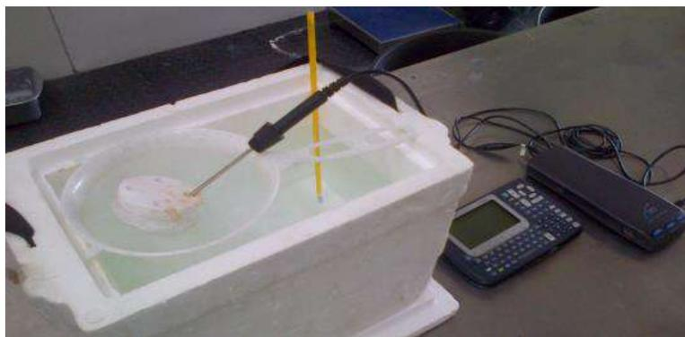
**Figura 1.** Montaje utilizado en la prueba de curado.
