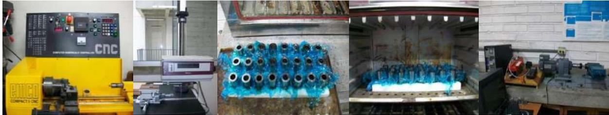
Maquinado → Rugosidad → Ensamble → Curado → Montaje de prueba
