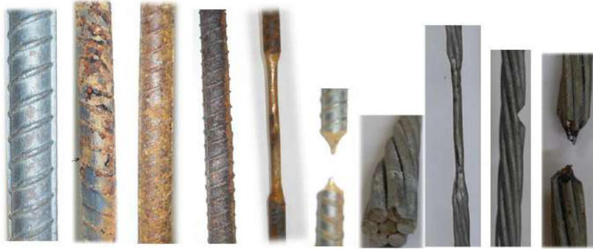
Figura 2. Estados de deterioro de barras y torones
