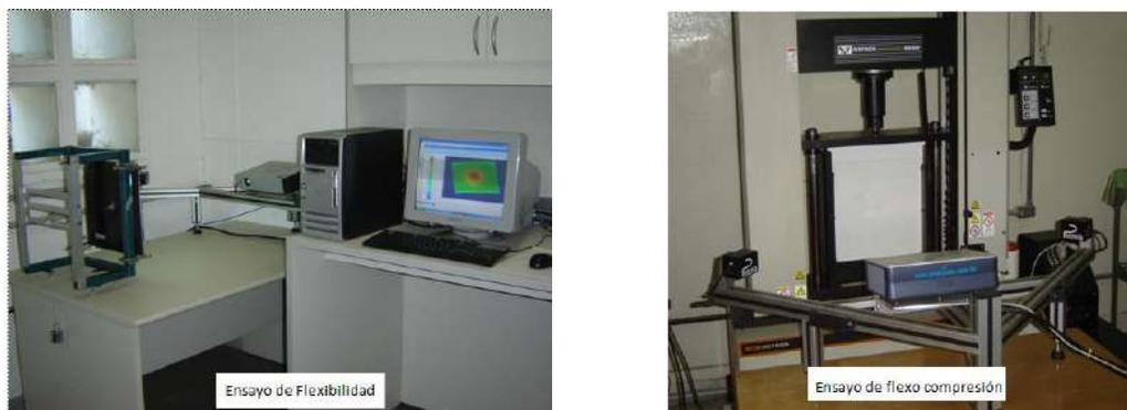
**Figura 2.** Ensayos de Flexibilidad y flexo compresión.
