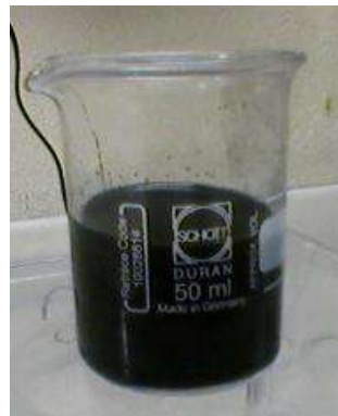
Figura 2. Aspecto de la suspensión de 0.5% en peso de NTC en el sol de sílice
