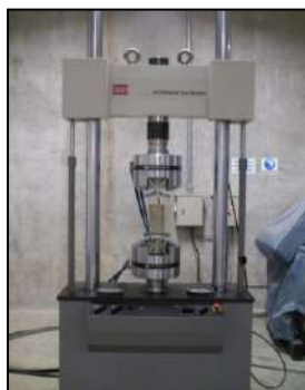
Figura 1. Ensayo de probetas a compresión.
