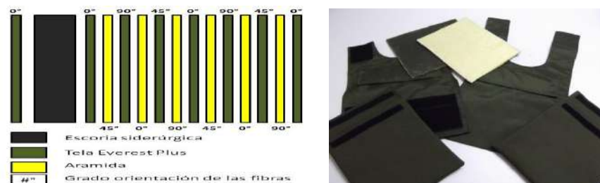
Figura 5. Configuración sistema de blindaje Nivel IIIA (Izquierda) y Sistema de protección balística personal Nivel IIIA desarrollado
