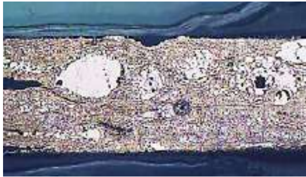
Figura 8. Microestructura de un botón de aleación Au-Pt fabricado por sinterizado con oro líquido, con 30% de reducción de espesor (40x) [12].
