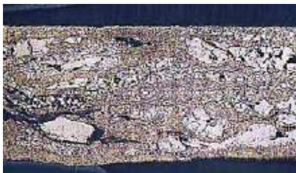
Figura 9. Microestructura de un botón de aleación Au-Pt sinterizado con oro líquido con 50% de reducción de espesor (80x) [12].
