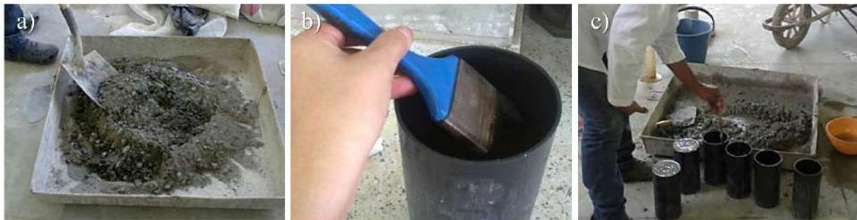
**Figura 6.** Preparación de mezclas de concreto. (a) Mezclado de arena, agregado y agua con cemento. (b) Recubrimiento interno de moldes cilíndricos de PVC con ACPM. (c) Llenado de los moldes.
