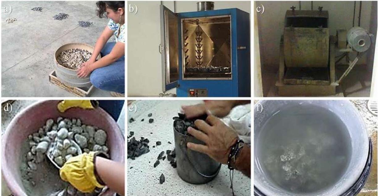
**Figura 5.** (a) Análisis granulométrico. (b) Determinación del porcentaje de humedad. (c)-(d) Ensayo de resistencia a la degradación de agregados gruesos por abrasión e impacto en la máquina Los Ángeles. (e) Determinación del peso unitario y porcentaje de vacíos. (f) Ensayo de densidad y absorción.
