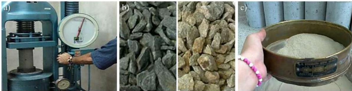
*Figura 7. (a) Ensayo de resistencia a la compresión. (b) Ensayo de resistencia al ataque con  $Mg_2SO_4$ . (c) Determinación del potencial de ASR.*
