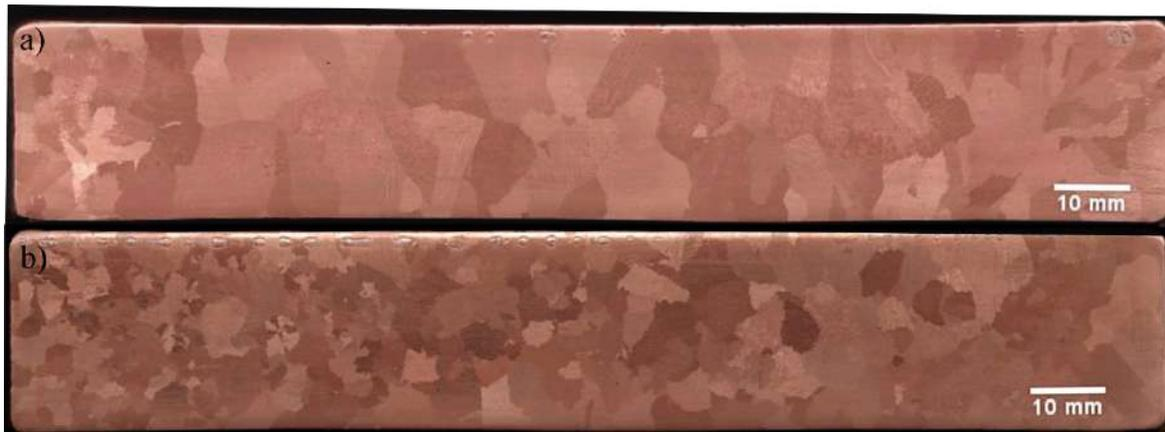
**Figura 3.** Macroestructuras de granos en orientación longitudinal de los lingotes. a) Cu8Sn-0%Zr(S) y b) Cu8Sn-0,16%Zr(I)-A.
