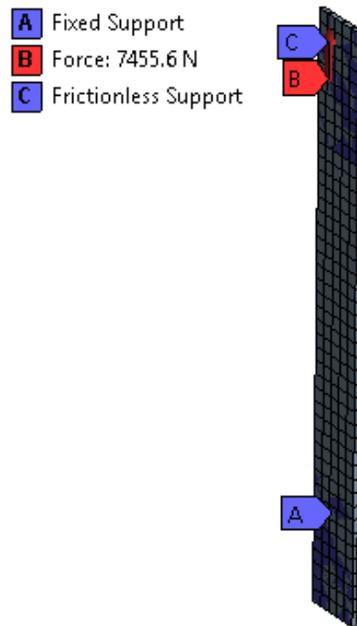
**Figura 2.** Esquema de la simulación de una probeta de tracción, condiciones de frontera y enmallado.
