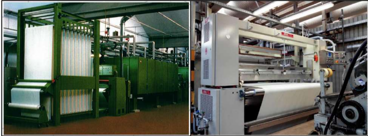
Figura 1. Línea de recubrimiento de textiles por transferencia [8].
