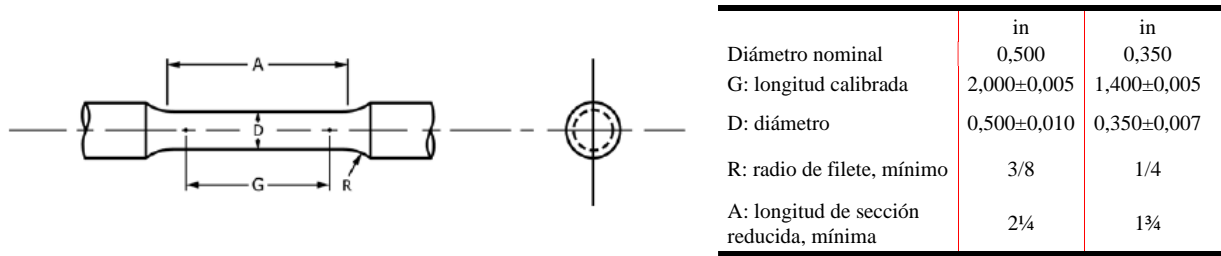
Figura 3. Geometría y dimensiones de los cuerpos de prueba para ensayos de tensión en bronce [8].
