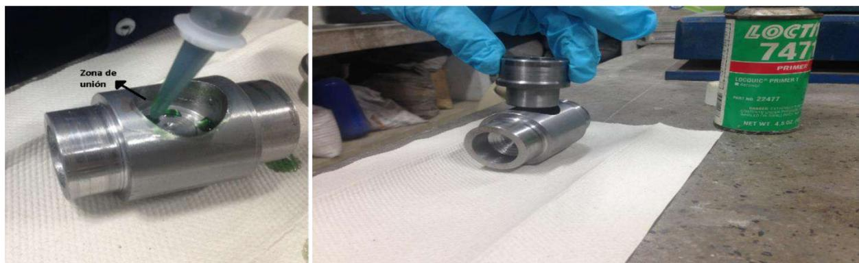
**Figura 2.** Aplicación de adhesivo en zona de unión eje central.
